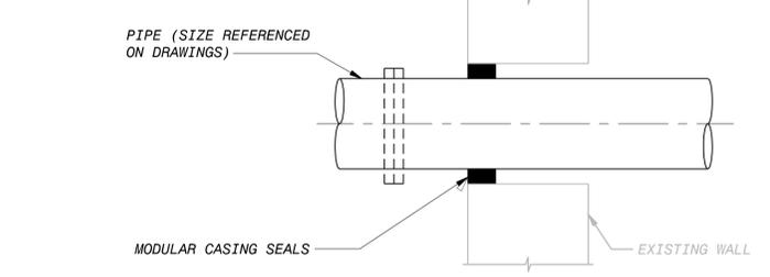
**E CORE DRILLED WALL OPENING**
