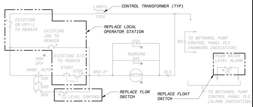
**MODIFIED SUMP PUMP CONTROL SCHEMATIC**
