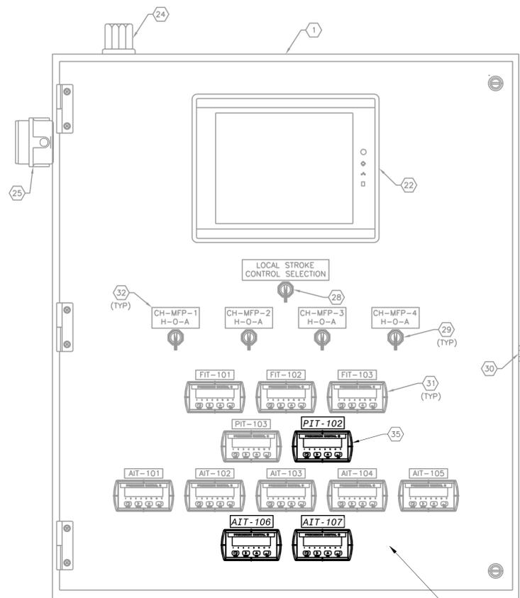
**METHANOL PUMP CONTROL PANEL
