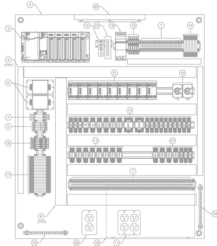
**METHANOL PUMP CONTROL PANEL
