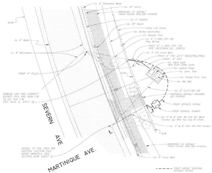
**SITE PLAN & BYPASS PLAN**
